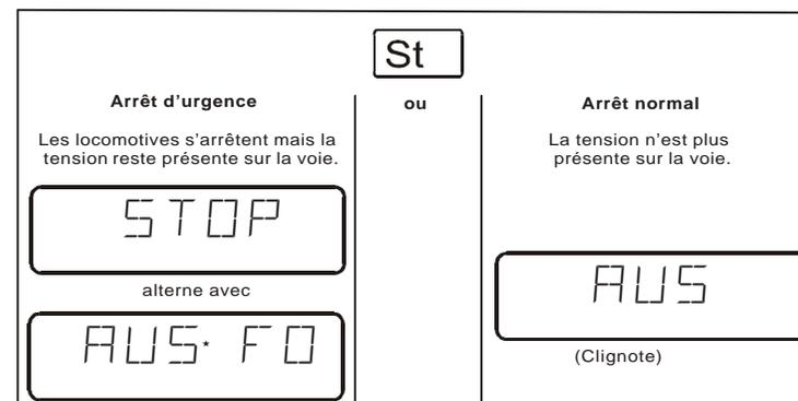
Le réglage en usine est l'arrêt d'urgence, cela signifie donc l'arrêt des locomotives tout en maintenant la tension sur la voie. En ce qui concerne le réglage de la touche 'St', voyez le chapitre «SET\_1: Réglage du fonctionnement de la touche 'Stop'».
