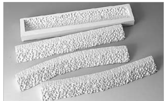
Form 6035 Uferbefestigung und Gießteile daraus, zum Teil gebogen (siehe „Gips biegen“).
