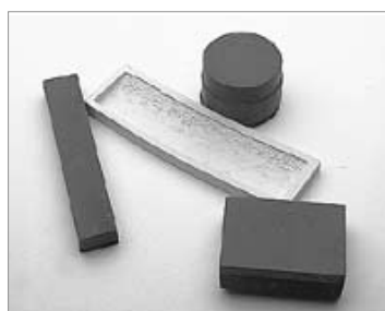
Oben: „Gebogene“ Gießteile des Komplettbahnsteigs 2154 und der Schüttnbahnsteigs 2159. Die durch das Biegen der Gummiformen verzerrten Stirnkanten müssen entsprechend nachgeschliffen werden.
